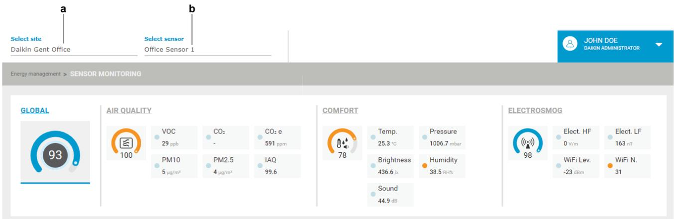
**Ergebnis:** Die Sensor monitoring (Sensor-Überwachung) des aktuellen Tages eines bestimmten IEQ-Sensors wird angezeigt. Standardmäßig wird zuerst der kombinierte Global (Global) Wert angezeigt.
