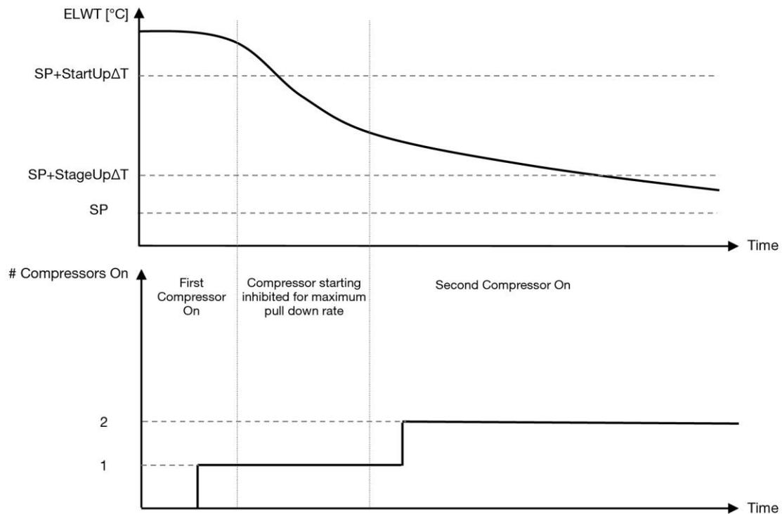
Diagramm 1 – Startsequenz der Verdichter – Kühlmodus
