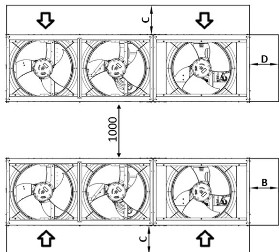
Abbildung 11 – Einheiten, die mit ihren längeren Seiten nebeneinander installiert werden (Fall 1 und Fall 2)
