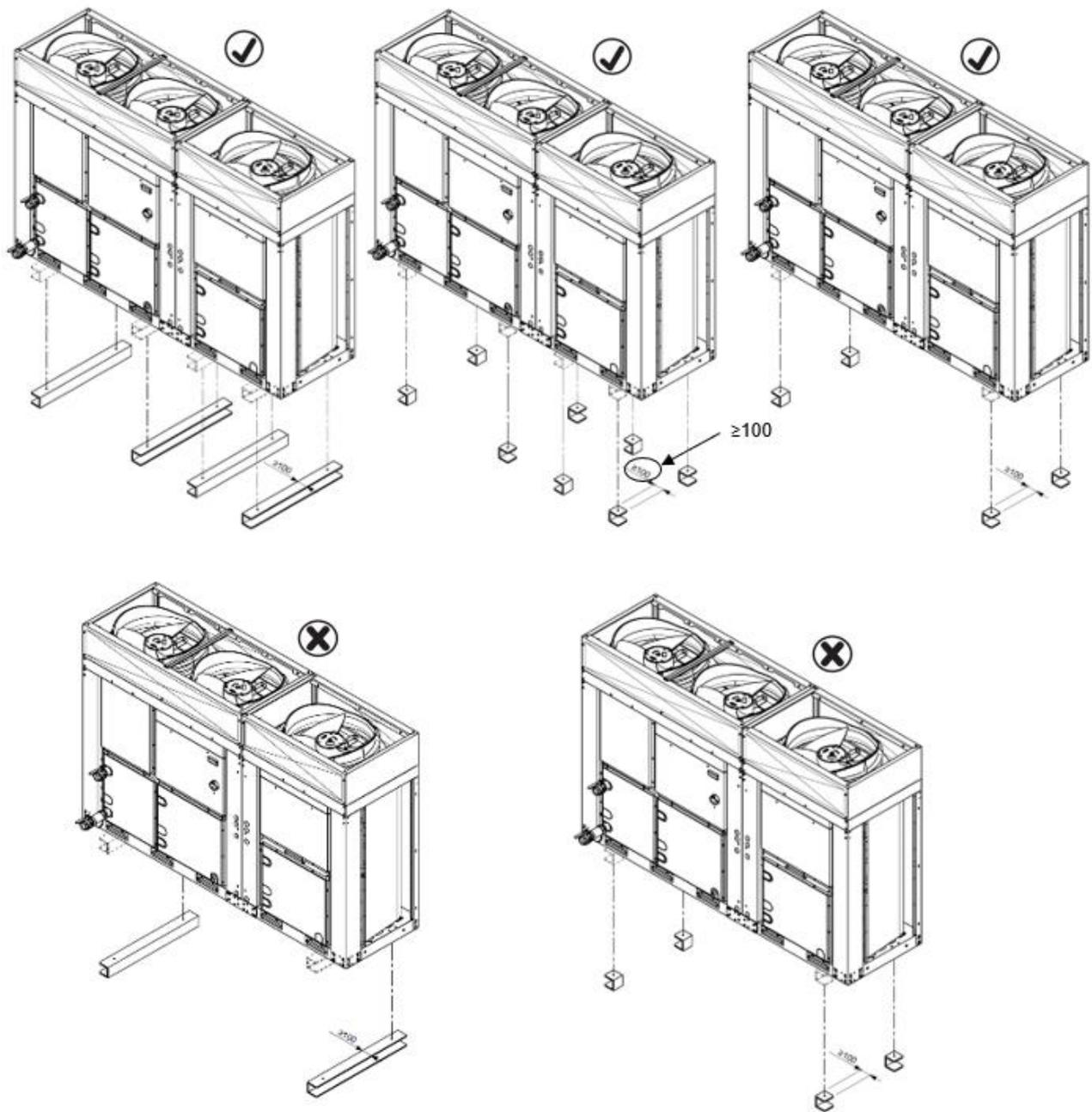
Abbildung 7 – Positionierung der DUAL-Einheit
