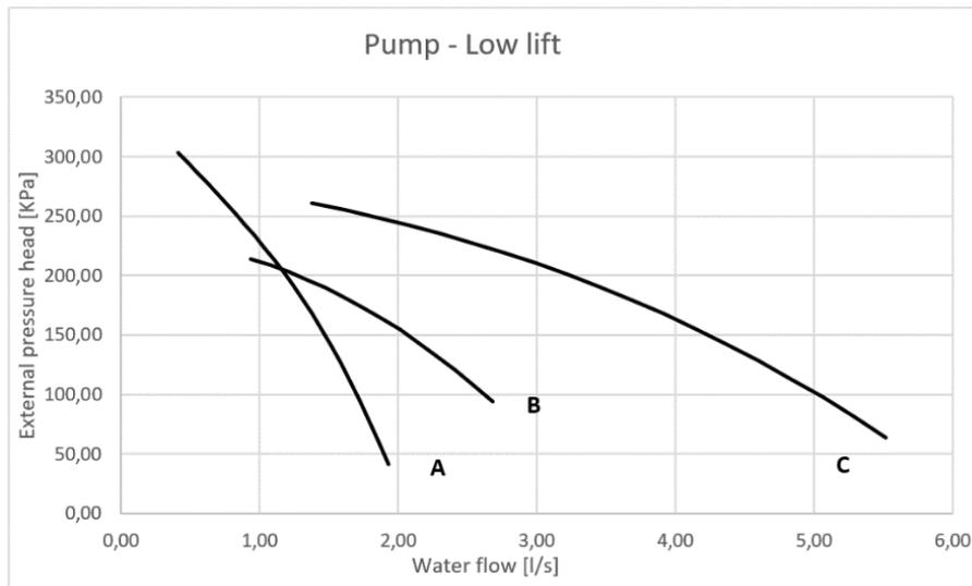
Abbildung 18 – Externe Druckhöhe der Wasserpumpe
