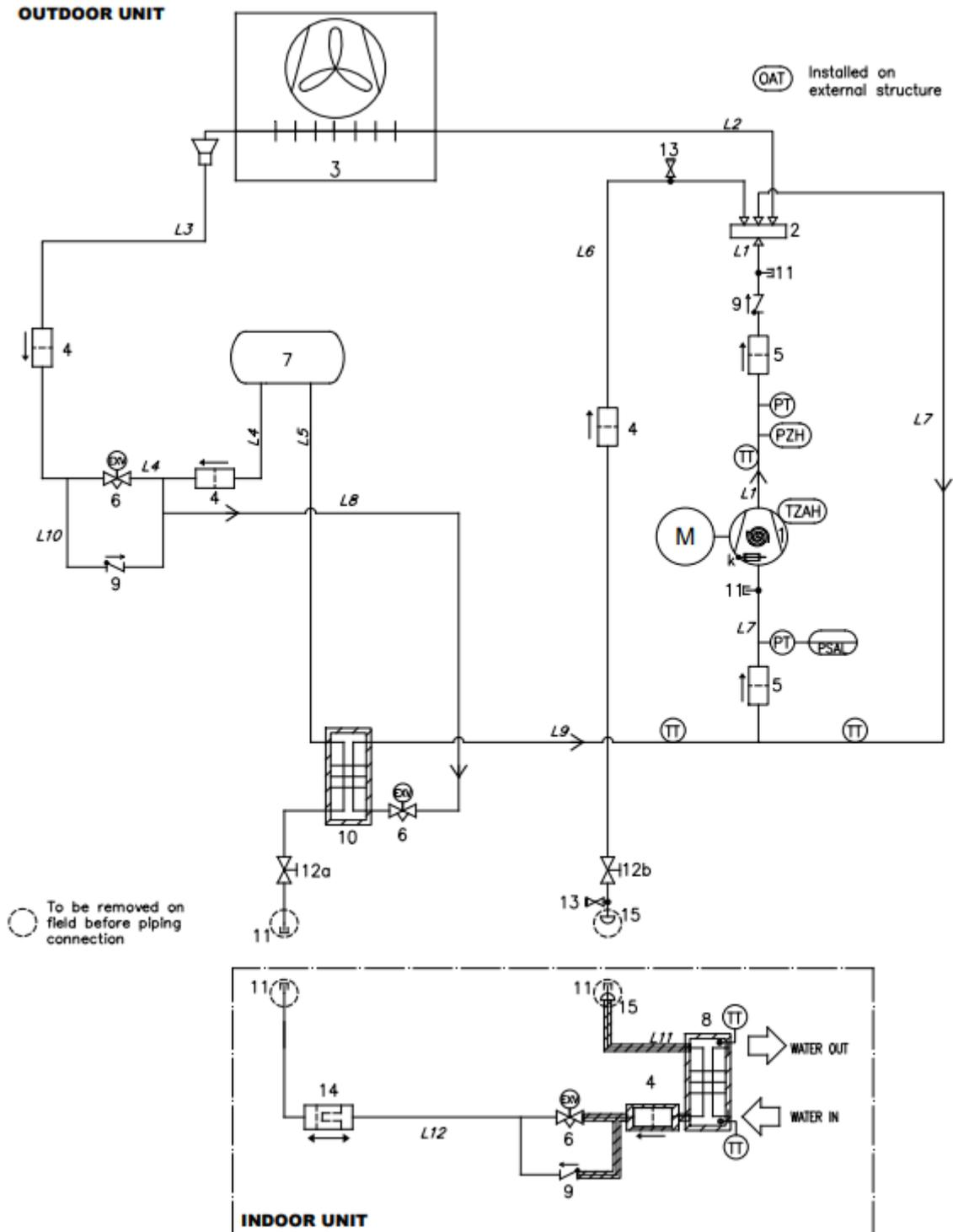
Abbildung 23 – Kältemittel (P&ID)-Kreislaufschema für MONO-Kreislauf EWYT~CZ-Gerät
