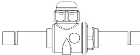
Abbildung 22 – Kugelventil
