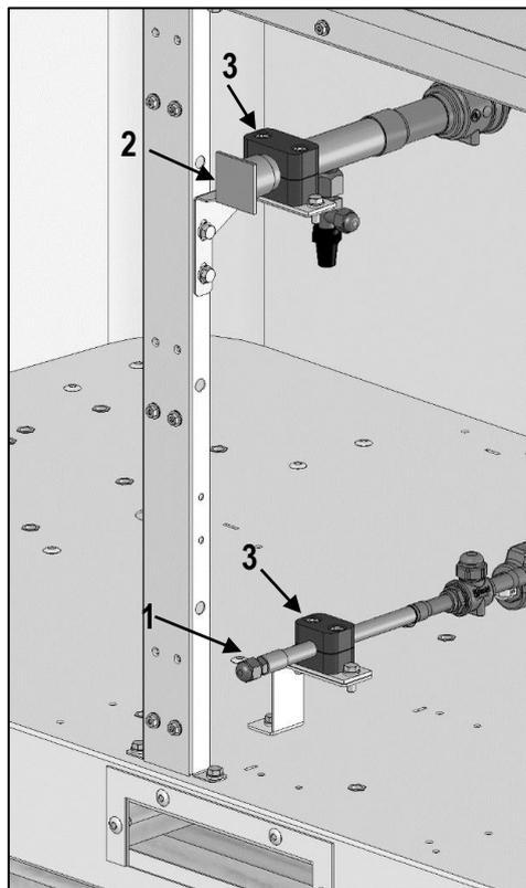
Hier oben ist das Detail der Außenverrohrung des Außengeräts dargestellt, das an das Rohrleitungssystem angeschlossen werden muss.
