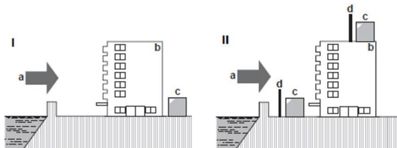
Abbildung 13 – Installation der Außeneinheit in Meeresnähe
