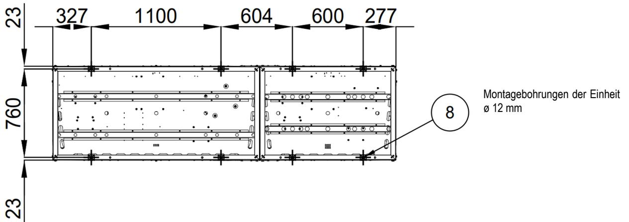
Abbildung 8 – Anordnung der Montagebohrungen (Ansicht von unten)
