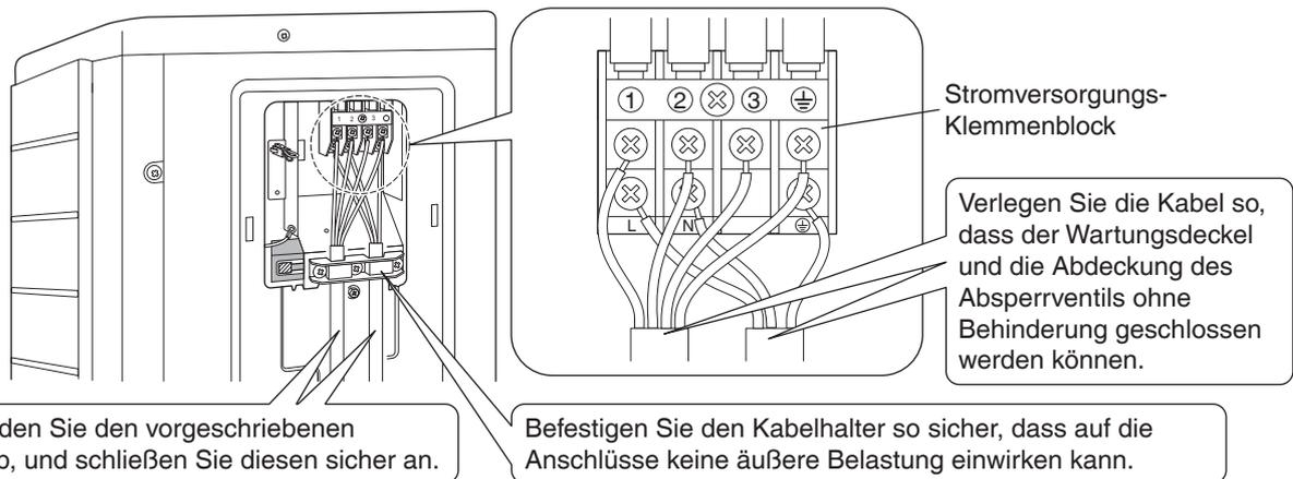
Beachten Sie die nachfolgenden Hinweise, wenn Sie die Verkabelung zu der Stromversorgungs-Klemmenleiste durchführen. Zu ergreifende Vorsichtsmaßnahmen für die Netzstromverkabelung.
