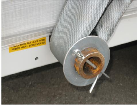
Abb. 3 Detail der Befestigung der Hebegurte an den Hebeschläuchen.
