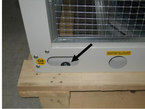
Abb. 1 Besondere Position der Schrauben zur Befestigung an der Palette
