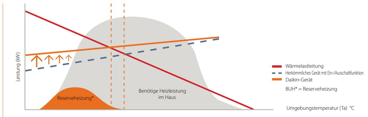
Verglichen mit herkömmlichen Geräten mit Ein-/Ausschaltfunktion wird für Sole/Wasser-Wärmepumpen von Daikin Altherma weniger Unterstützung durch die Reserveheizung benötigt, dank des Zusatzeffektes unserer Inverter-Verdichter, wodurch es ebenfalls zu einer Reduzierung der Betriebskosten kommt.
