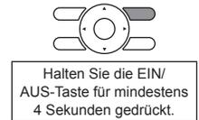
**7-17** Falls der letzte Fehlercode angezeigt wird, führen Sie die Fehlerdiagnose gemäß der "Fehlercodeliste" in der Installationsanleitung des Innengerätes durch. Nachdem die Fehlerdiagnose beendet ist, halten Sie die Ein/Aus-Taste auf dem Bildschirm "Servicekontakt/Modellinfo" für mindestens 4 Sekunden gedrückt, um das Fehlercode-Protokoll zu löschen.
