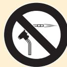
Die abgeklemmte Rohrleitung **NIEMALS** durch Löten entfernen.
