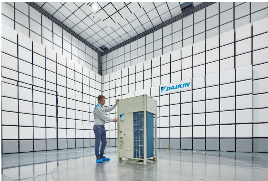
Daikin verfügt im EDC über spezielle EMV-Testräume zur Prüfung der elektromagnetischen Verträglichkeit von Komponenten. © Daikin
