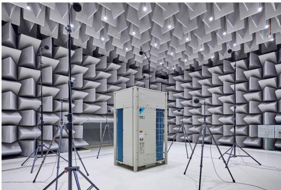
Das Daikin Europe Forschungs- und Entwicklungszentrum in Gent verfügt über 23 hochmodernen Testkammern, darunter Schalltesträume, in denen beispielsweise der Schallpegel von Wärmepumpen geprüft wird. © Daikin
