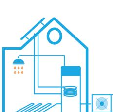
Luft/Wasser-Niedertemperatur-Wärmepumpen sorgen für Heizung, Warmwasser und optional für Kühlung. Sie sind ideal für Fußbodenheizungen und moderne Heizkörpersysteme.
